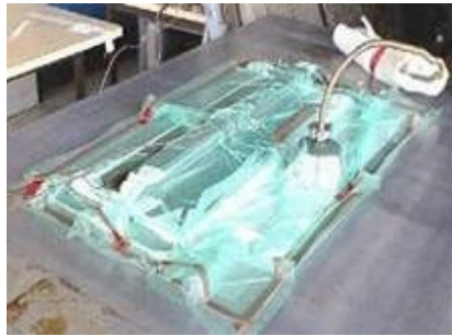
Imagen 4. Fabricación de pieza por infusión. AIRBUS
